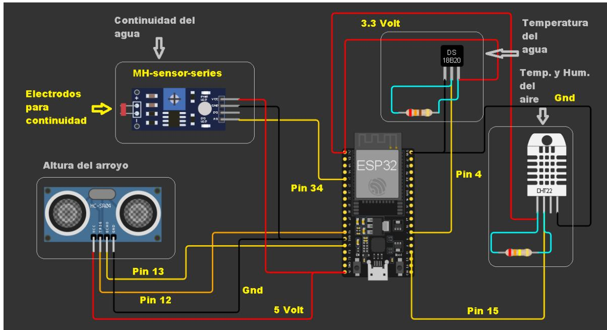
Incluye una imagen del diagrama del circuito, con los sensores conectados a sus pines correspondientes del ESP32. Acordarse de colocar correctamente las alimentaciones (3.3V o 5V) para cada componente según sus requerimientos.
